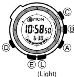
На рисунке изображен общий вид часов в Режиме Текущего Времени. Последовательное нажатие кнопки “D” обеспечивает переход из разряда в разряд в следующей последовательности: Режим Текущего Времени – Режим Лунного Времени – Режим Таймера Обратного Отсчета – Режим Секундомера – Режим Мирового Времени – Режим Звукового Сигнала – Режим Записной Книжки – Режим Калибровки – Режим Текущего Времени.
