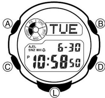
На рисунке изображен общий вид часов в Режиме Текущего Времени. Последовательное нажатие кнопки “С” обеспечивает переход из разряда в разряд в следующей последовательности: Режим Текущего Времени – Режим Мирового Времени – Режим Звукового Сигнала – Режим Секундомера – Режим Таймера Обратного Отсчета – Режим Текущего Времени.
