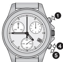
Функция РАЗДЕЛИТЬ позволяет останавливать стрелки для считывания промежуточного времени, в то время как отсчет времени продолжается. При повторном запуске стрелки «наверстывают» истекшее время.
