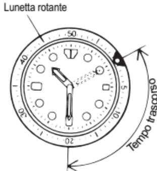
Essendo provvista di un meccanismo di protezione che ne impedisce la rotazione a forza o per impatto, la lunetta non può essere ruotata al contrario. Le cifre disposte sulla lunetta facilitano infine la lettura dell'ora attuale.
